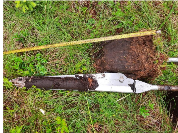
Torferkundung mit Klappsonde
